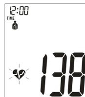
c) W momencie zakończenia pomiaru wynik pojawi się na wyświetlaczu. Zawiera on wynik ciśnienia skurczowego, rozkurczowego oraz puls.
